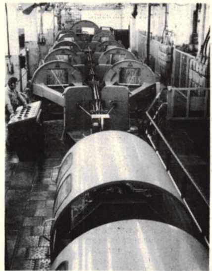
Voor het torsievrij slaan van telefoonkabels en voor het vervaardigen van coaxkabels, ontwikkelde Krupp een nieuwe draadslagmachine. De maximale tordering bedraagt ongeveer 2%.
